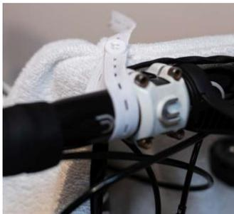
Befestige den Gummizug um den Lenker oder den Vorbau oder das Steuerrohr (im Bild um den Lenker).
