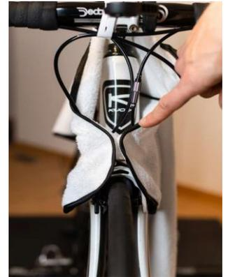
**Lege den Vorderteil passend über Deinen Lenker. Die nach vorne ragende „Zunge“ kann bei Roadbikes mit einem Druckknopf um die Felge fixiert werden. Bei Triathlon- / Zeitfahrrädern wird die Zunge über die Extensions gelegt. Im Bild schützt die Zunge das Vorderrad.**
